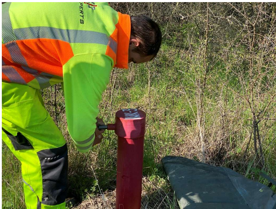
Obr. 6 Inklinometrické meranie na vrte INK –3 , situovaný v strednej časti predmetného územia.
