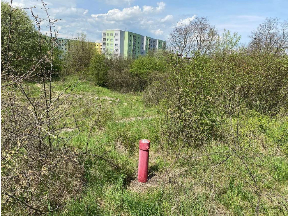
Obr. 4 Inklinometrický vrt INK –2 , vystupuje na okraji sídliska Sekčov, východne od ul. Sibírska.
