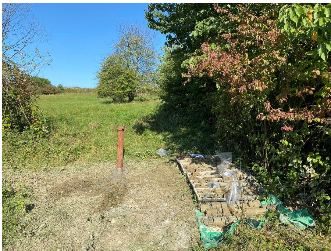
Obr. č. 14 Realizovaný vrt INK – 7 s vrtným jadrom
