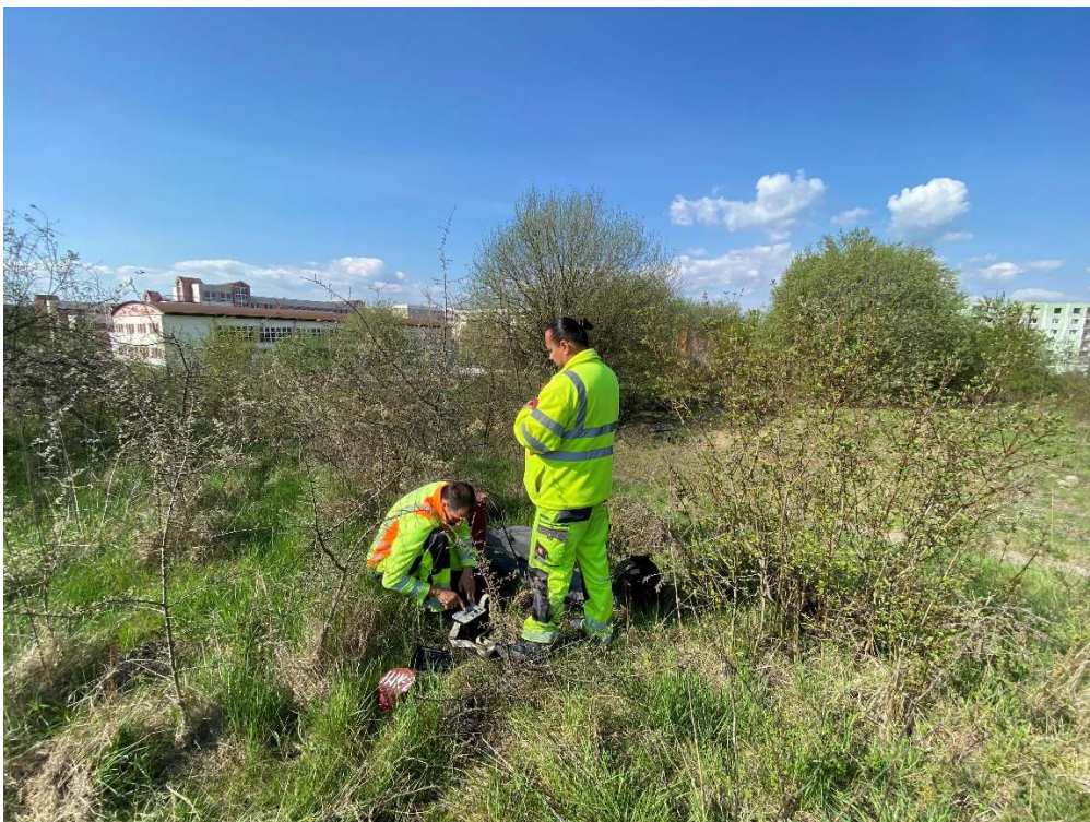
Obr. 5 Inklinometrické meranie na vrte INK –2 , vystupuje na okraji sídliska Sekčov, východne od ul. Sibírska.
