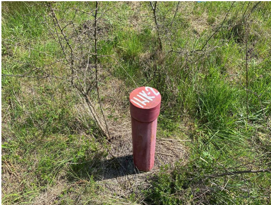
Obr. 3 Inklinometrický vrt INK –2.
