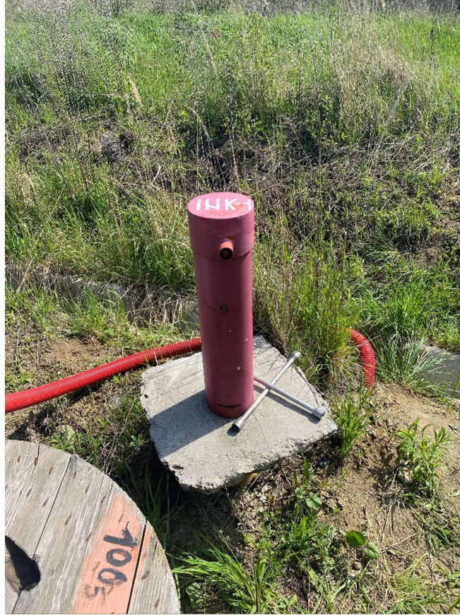
Obr. 2 Inklinometrický vrt INK –1, v hĺbke 8,0 m „strihnutý“.
