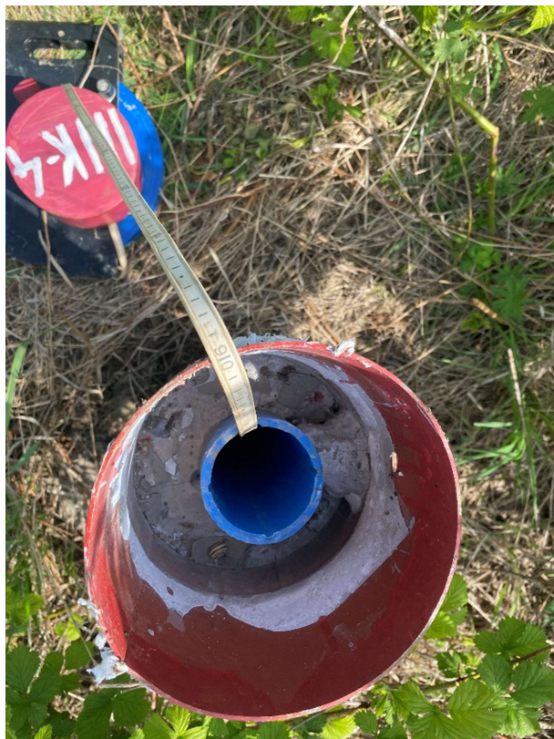
Obr. 10 Inklinometrický vrt INK –4, meranie hladiny podzemnej vody.
