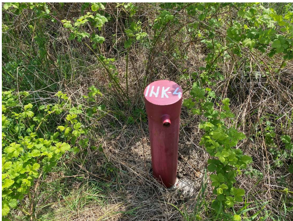
Obr. 9 Inklinometrický vrt INK –4.
